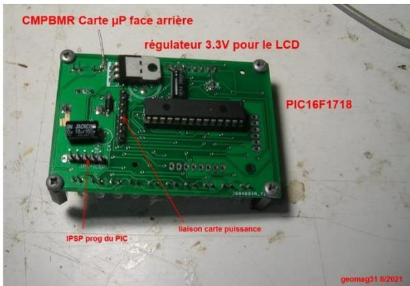
L'autre face supporte le µP, la liaison vers la carte puissance, le régulateur 3.3V pour le LCD, et le connecteur 6 points (5 utiles) de programmation du PIC par le programmeur PicKit3 de Microchip. Un connecteur est prévu pour rajouter un module µSDCARD, mais il faut remplacer dans ce cas le PIC16F1718 par un PIC18F27Q43 qui a plus de capacité de flash programme.
