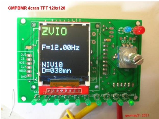
La carte commande du proto comporte l'afficheur TFT couleur 128x128 (ebay), l'encodeur (ebay) et les LEDs sur la face cuivre. L'encodeur issu de ebay tourne à l'envers des encodeurs du site RadioSpares, mais une configuration permet de choisir le sens de rotation.
