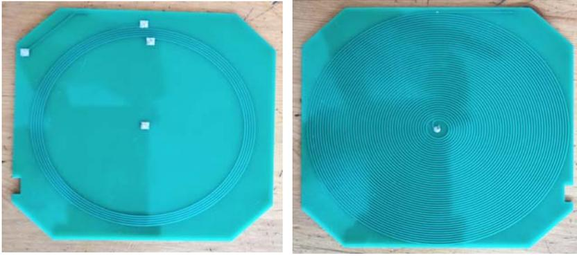
**ANTENNES SUR CIRCUIT IMPRIME Diamètre 116mm**
